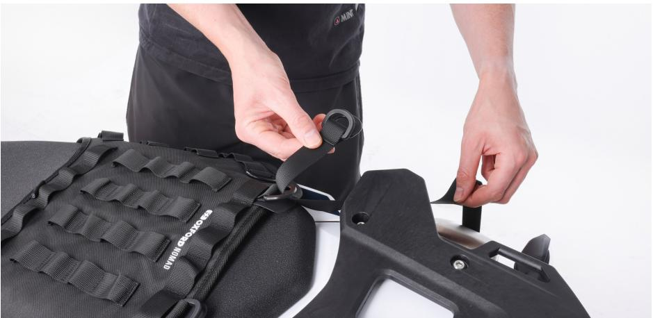
4. Zoek een plaats om de riemen met D-ring (**B**) rond het frame van de motorfiets te bevestigen, zodat ze niet in de weg zitten van de ketting, de voetsteunen of de voethendels.
