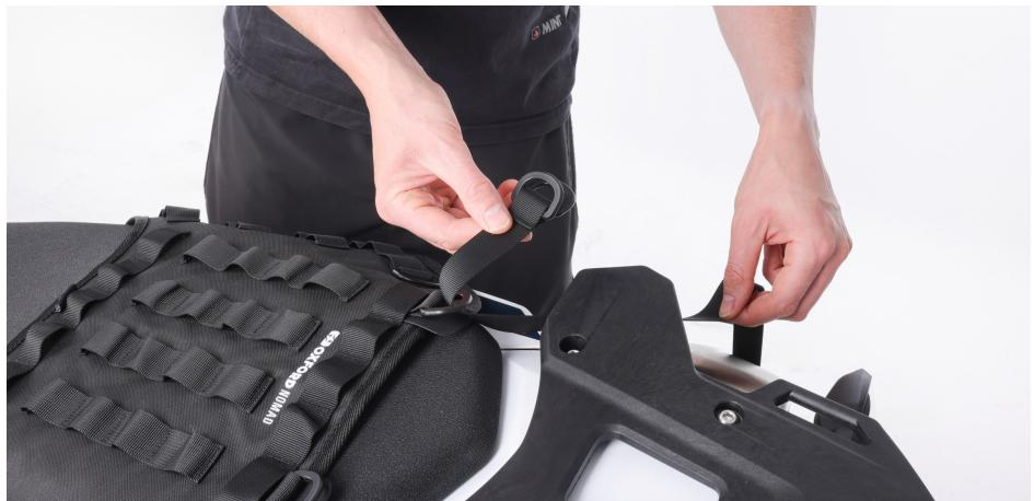
4. Hitta en plats att fästa remmarna med D-ring **(B)** runt motorcykelns ram så att de inte kommer i vägen för kedja, fotstöd eller fotreglage.
