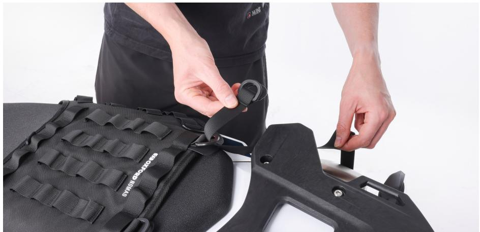
4. チェーン、フットペグ、フットレバーを邪魔しないように、モーターサイクルのフレームの周りに D リング ストラップ (B) を固定する場所を探します。
