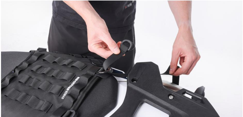
4. Suchen Sie eine Stelle am Motorradrahmen, an der Sie die D-Ring-Gurte (**B**) befestigen können, so dass sie nicht mit der Kette, den Fußrasten oder den Fußhebeln in Konflikt geraten.
