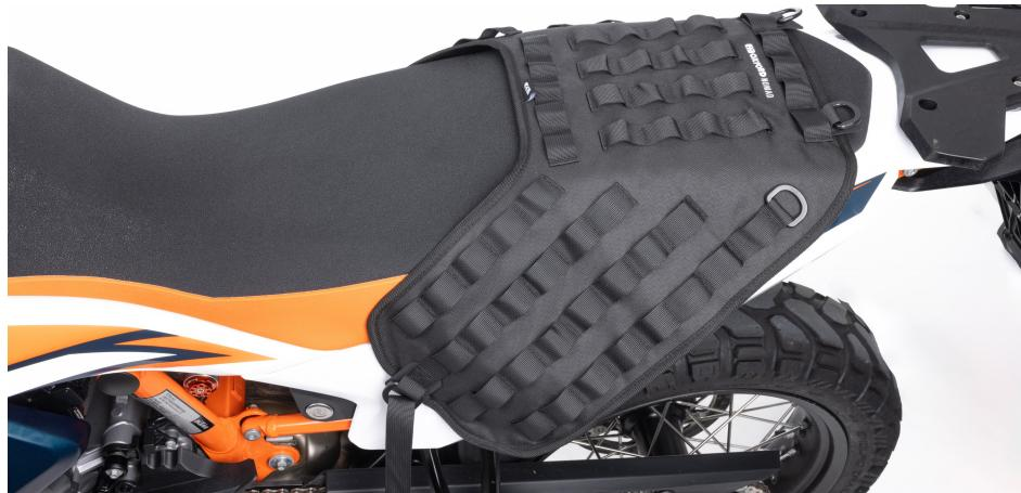
2. Bruk de medfølgende D-ringstroppene **(B)** til å finne et passende sted bak på motorsykkelen for å feste stroppene.
