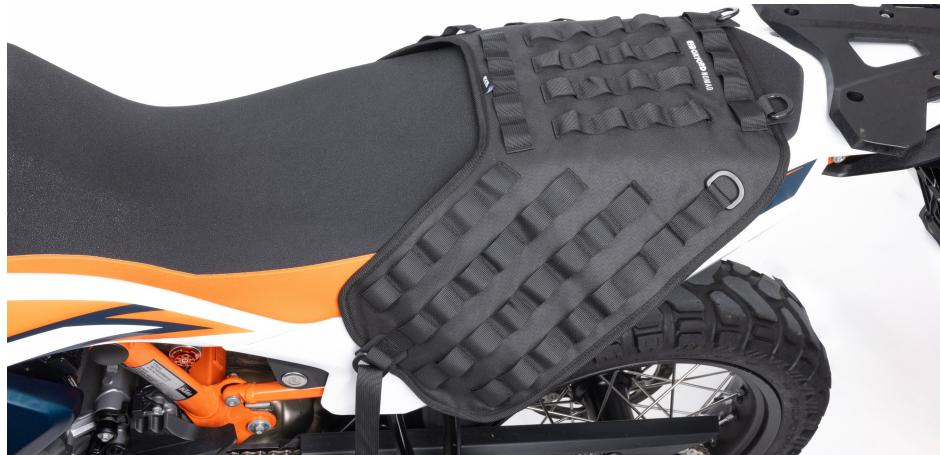
2. Använd de medföljande remmarna med D-ring **(B)** och hitta en lämplig plats bak till på motorcykeln för att fästa remmarna.
