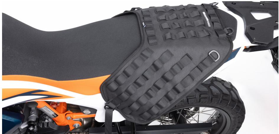
2. Greifen Sie zu den mitgelieferten D-Ring-Gurten **(B)** und suchen Sie eine geeignete Stelle am Heck des Motorrads, um die Gurte zu befestigen.
