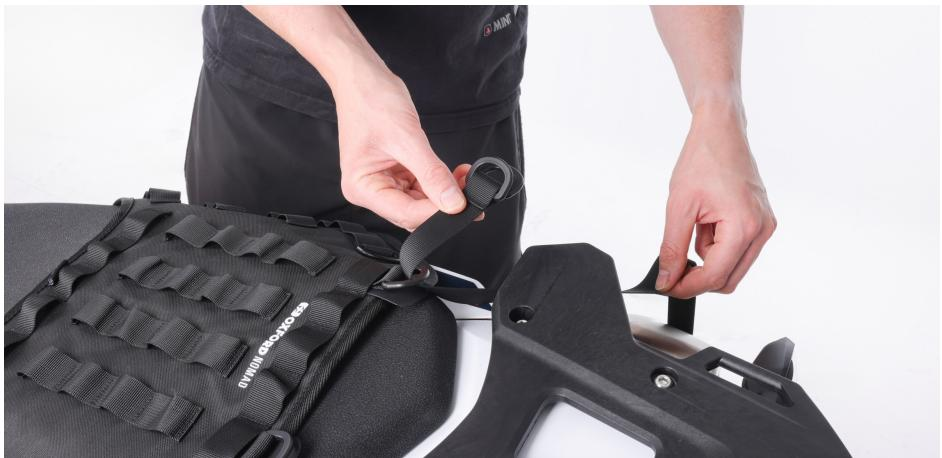
4. Encontre um local para fixar as correias com anel em "D" (**B**) à volta do quadro do motociclo, de modo a não interferirem com a corrente, os apoios dos pés ou as alavancas dos pés.
