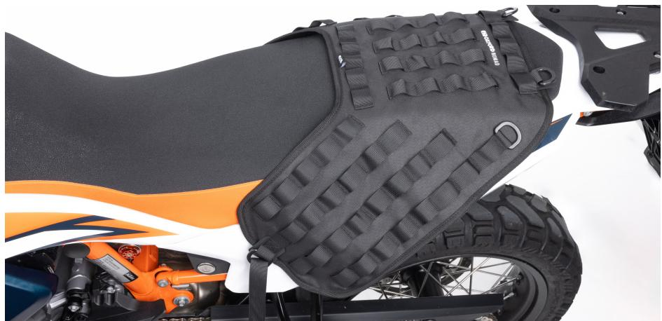
2. Utilizzando le cinghie con D-ring **(B)** in dotazione, trovare una parte adatta verso il retro della moto per fissare le cinghie.
